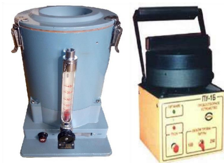
Рисунок 66 - Прибор Кротова и пробоотборное устройство ПУ-1Б. Займствовано из Интернет-ресурсов.
