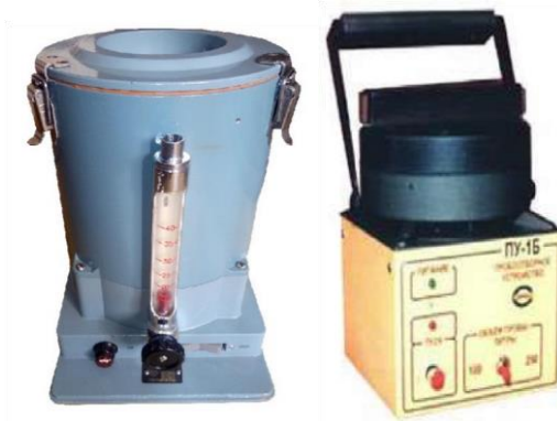
66 сурет - Кротовтың құрылғысы және СҚ-1Б сынама алу құрылғысы. Интернет желісінен алынған.
